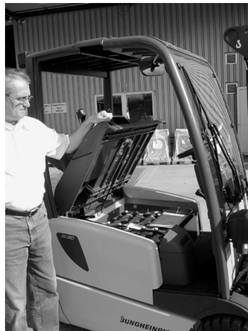
5 Sollevamento del coperchio del cofano batteria durante la carica per dissipare la miscela esplosiva di gas
