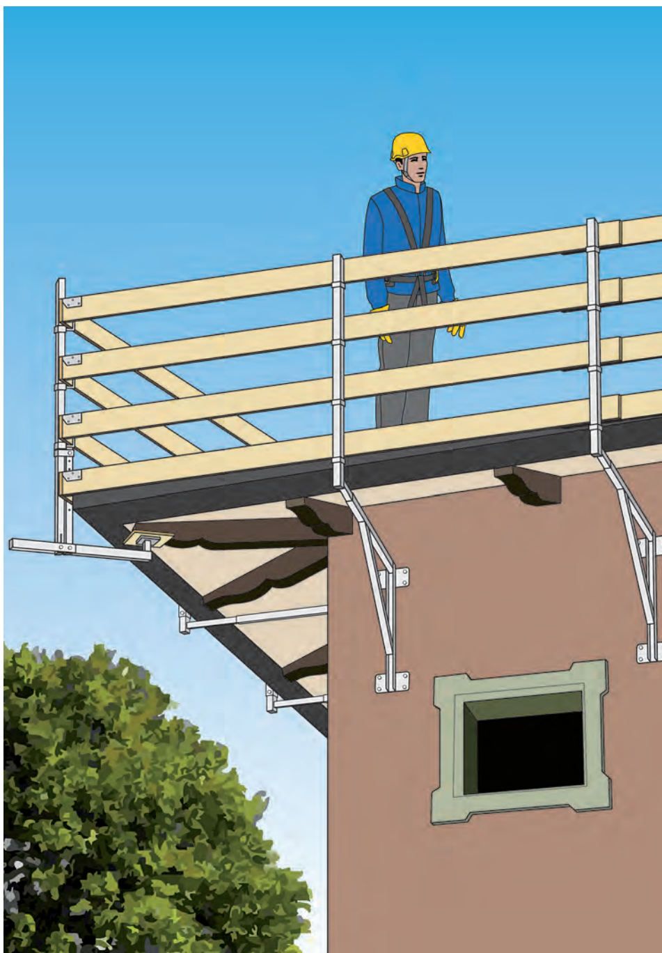
Figura 6 - Parapetto provvisorio con gancio sottocoppo
