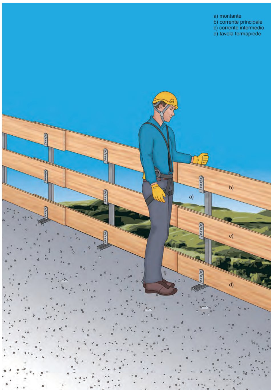
Figura 1 - Elementi costituenti il parapetto provvisorio
